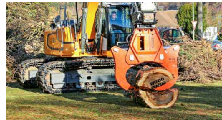
Einfache Zuführung des vorgespaltene Materials in Zerkleinerungsanlagen.
