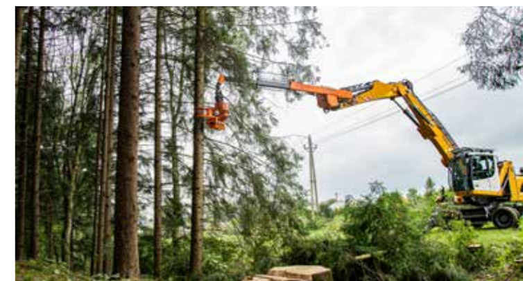
Teleskop mit 2-fachem Ausschub.
