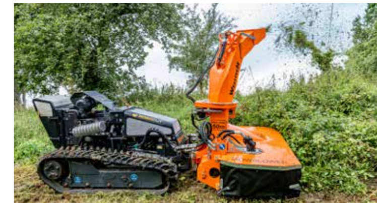
Der Mowblower® kann an ferngesteuerte Geräteträger angebaut werden.
