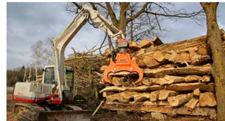
Vorspaltung von Holz für die natürliche Trocknung.
