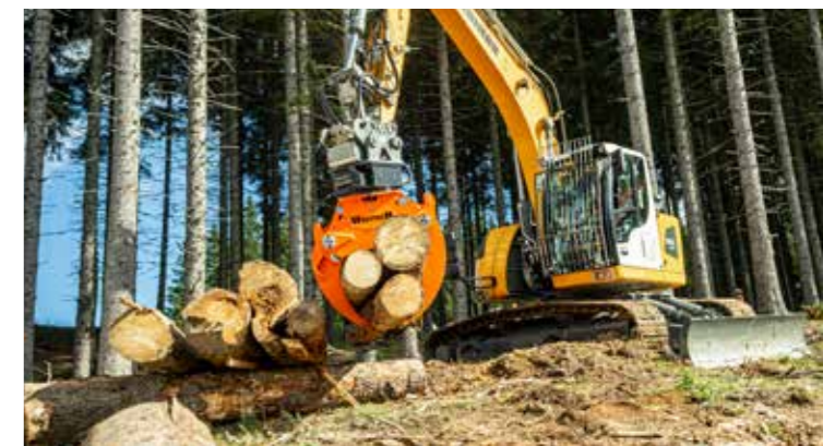
Greiferöffnung bis zu 1720 mm.
