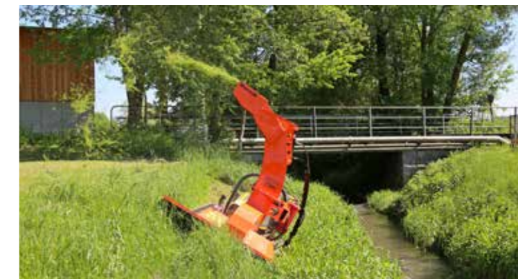
Mäht an Stellen, die mit einem Auslegermäher nicht erreicht werden können.
