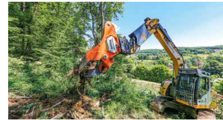
Schonende Entnahme des Stocks aus dem Boden.
