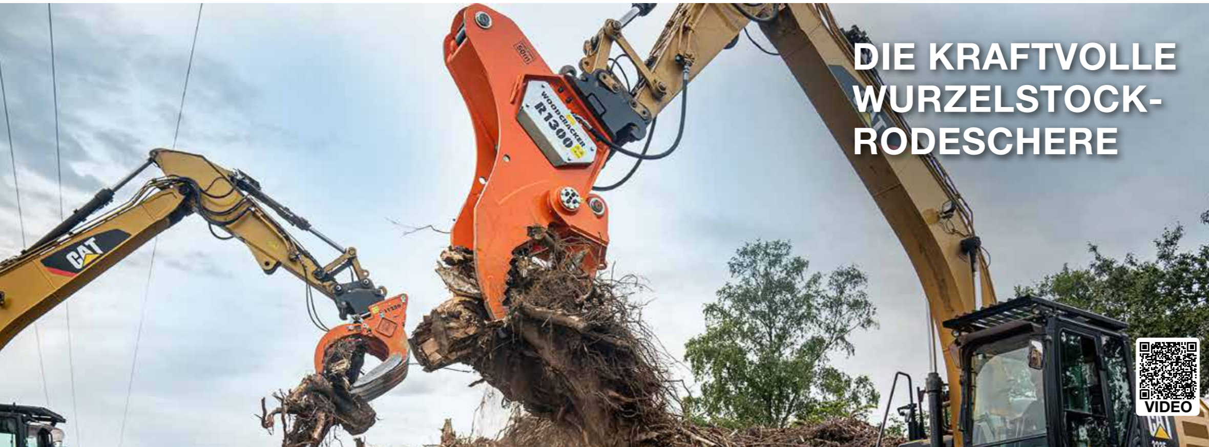
Schonende Entnahme des Stocks aus dem Boden.
