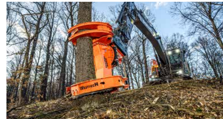
Schneiddurchmesser bis 700 mm.
