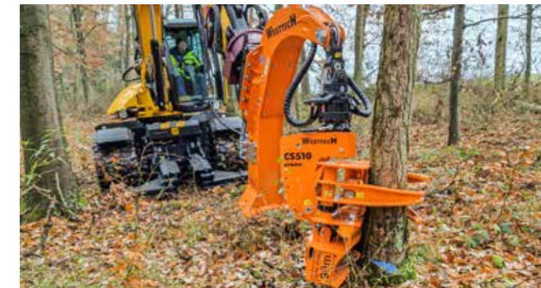
Schreitfuß mit Woodcracker® CS510 crane.
