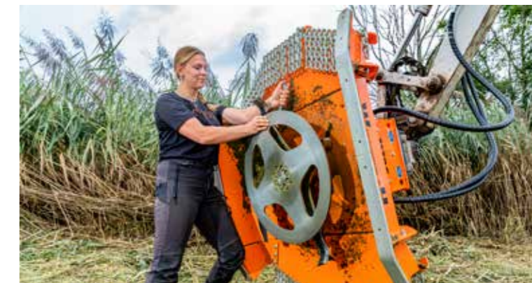
Einfaches Messerwechseln, tauschbare Verschleißkufen.
