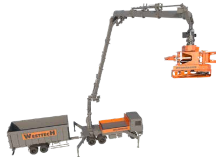
Woodcracker® CS510 crane am Fly-Jib für große Reichweite
