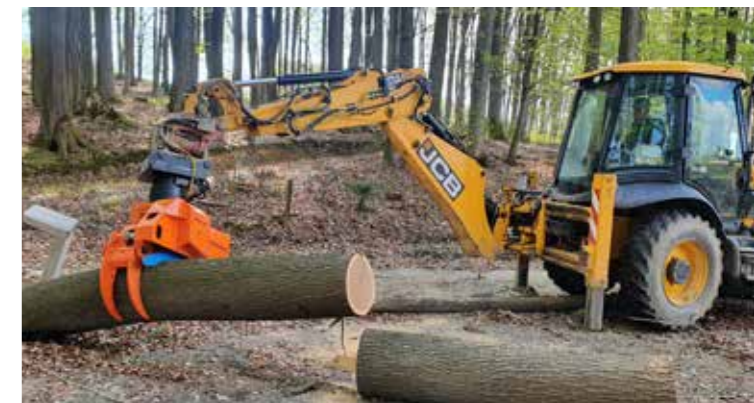
Robuster und verschleißbarer Holzgreifer, inkl. Säge.
