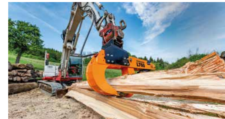
Der Stamm kann in einem Arbeitsschritt gespalten und aufgeladen werden.
