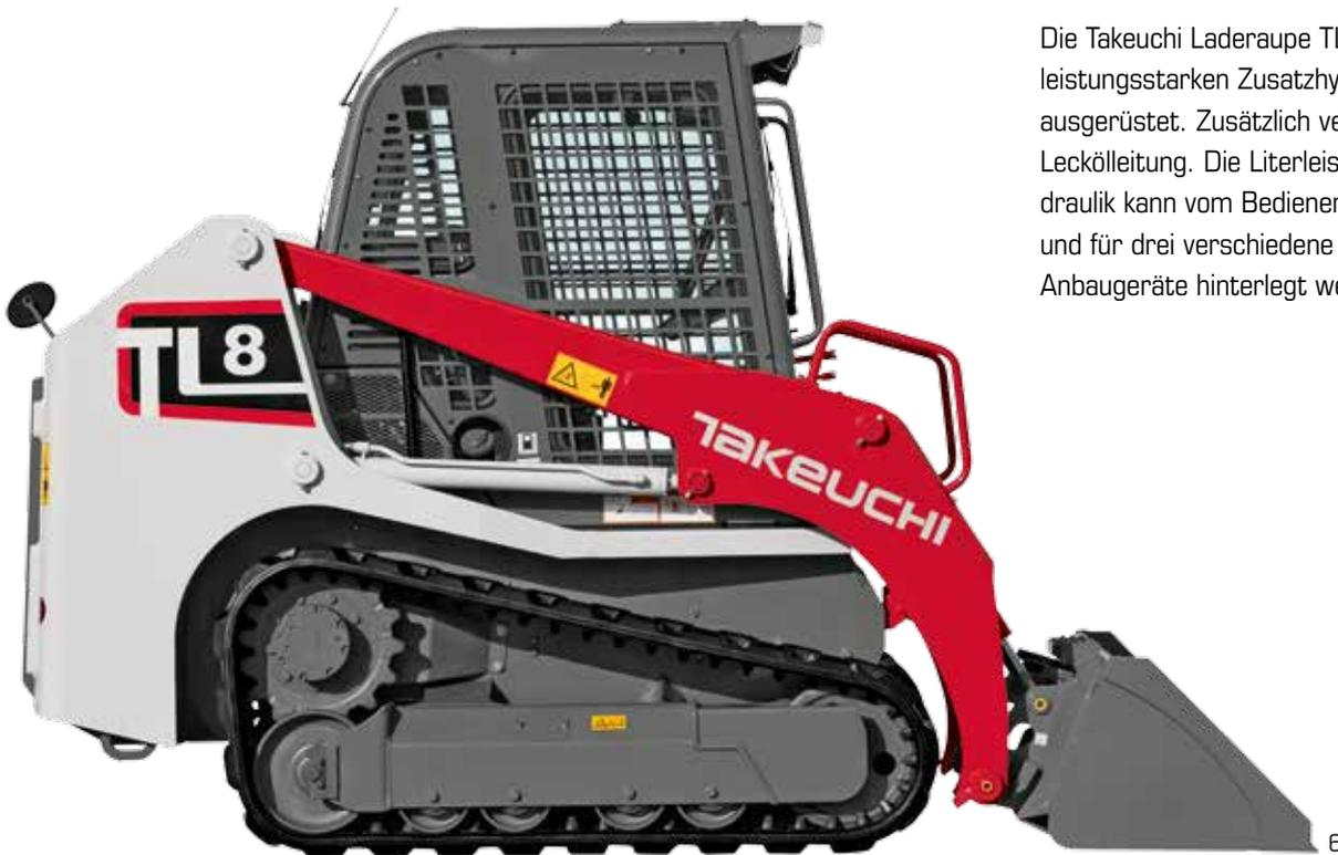
Die Takeuchi Laderaupen TL 8 sind mit einer leistungsstarken Zusatzhydraulik mit 72 l/min ausgerüstet. Zusätzlich verfügt sie über eine Leckölleitung. Die Literleistung der Zusatzhydraulik kann vom Bediener einfach eingestellt und für drei verschiedene hydraulische Anbaugeräte hinterlegt werden.
