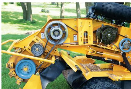
**LEICHTER RIEMENWECHSEL.** Für eine leichte und schnelle Wartung befinden sich alle Riemen auf einer Seite der Maschine. Der Riemenantrieb des Fräsrades wird über bewegliche Umlenkräder eingestellt. Zusätzlich kann jeder Riemen unabhängig voneinander justiert werden.
