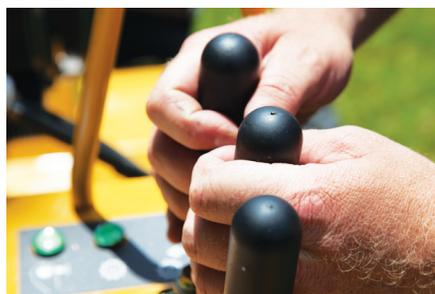
**BEDIENERSICHERHEITSSYSTEM.** Die modifizierten Bedienerhebel für das Schwenken, Auf- und Abbewegen des Fräsauslegers sowie für den Maschinenantrieb sind mit einem integrierten und robusten Tastsensor-Sicherheitssystem ausgestattet. Diese bedienerfreundliche „Totmanschaltung“ trägt zum Schutz des Bedieners bei und erhöht die Sicherheit wesentlich.
