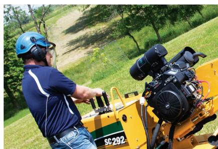
**ZWEIGANG-FAHRANTRIEB.** Der Bediener kann beim Betrieb zwischen zwei Fahrgeschwindigkeiten wählen. Mit dem höheren Gang (0-40,5 m/min) lässt sich die Maschine schnell zwischen den Baumstümpfen fortbewegen, der niedrige Gang (0-20,1 m/min) ist für das Manövrieren um den Stumpf geeignet.
