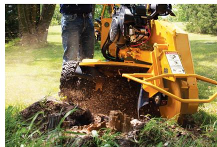
**AUTOSWEEP®SYSTEM.** Mit dem optionalen AutoSweep®System stellt sich die Fräsgeschwindigkeit während des Betriebs automatisch ein, wodurch die Belastung des Motor und Antriebsstrang reduziert wird.
