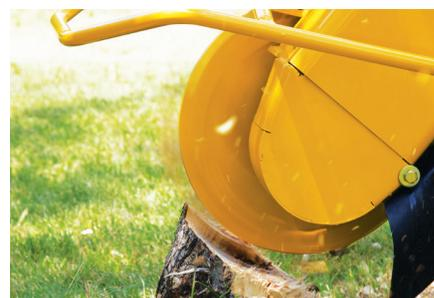
**YELLOW JACKET™ FRÄSZAHNSYSTEM.** Das Vermeer exklusive Yellow Jacket™ Fräszahnsystem garantiert einen schnellen, einfachen Service und eine lange Lebenszeit der Zähne und Halter.
