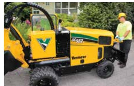
**BEDIENSTATION AN DER HINTERSEITE.** Bei engen Durchfahrten, welche ein Manövrieren über das seitlich angebrachte Bedienpult nicht zulassen, hat man die Möglichkeit mit den hinten angebrachten Funktionshebeln die Maschine zu fahren.
