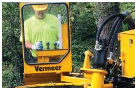
**BEDIENERSICHERHEITSSYSTEM (TOTMANNSCHALTUNG).** Dieses benutzerfreundliche Sicherheitssystem schützt den Bediener und erhöht die Sicherheit. Sobald die Hände des Bediener die Steuerhebel länger als eine Sekunde verlassen, stoppt das Fräsrads und die Kontrollleuchte erlischt.
