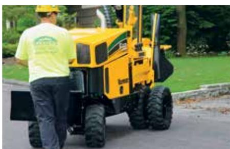
**ALLRADANTRIEB MIT DIFFERENTIALSPERRE.** Durch den Allradantrieb ist es der SC552 möglich unebenes Terrain problemlos zu überqueren. Die zusätzliche Differentialsperre hält die Traktion der Maschine auch bei schwierigsten Geländebedingungen.
