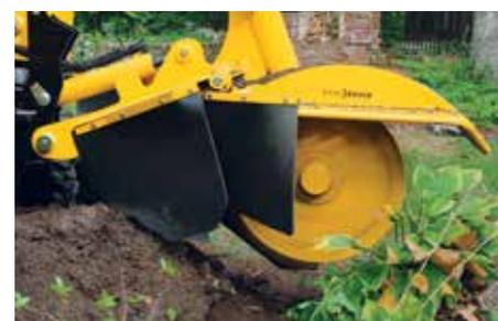
**PROBLEMLOSES FRÄSEN.** Das exklusive SmartSweep™ System reguliert die Motordrehzahl und Fräsgeschwindigkeit während des Betriebs für ein ruhiges und gleichmäßiges Arbeiten des Fräsrades.
