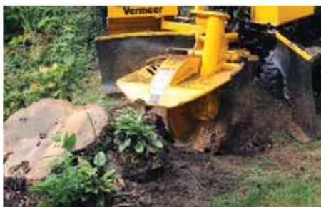
**MAXIMALE FRÄSBREITE.** Die SC552 bietet einen Fräsbereich über Planum von 78,7 cm sowie einen Fräsbereich unter Planum von 63,5 cm. Mit ihrem Schwenkradius von 182,9 cm ist es möglich größere Baumstümpfe zu fräsen, ohne die Maschine stets neu zu positionieren.
