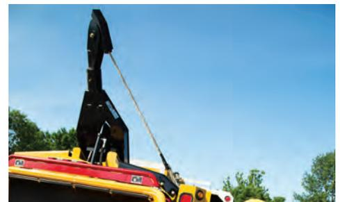
**OPTIONALE SEILWINDE.** Mit der Winde ist es nicht mehr nötig, großes Material zum Häckslers zu schleppen. Die 45,7 m Seilwinde kann Material bis zu 1814,9 kg handhaben und erleichtert die Beladung auf den Einzugsstisch. Zusätzlich kann die Seilwinde auch hydraulisch aus dem Arbeitsumfeld gesteuert werden, um den Häckslers mit einem Beladungsgerät zu bestücken.
