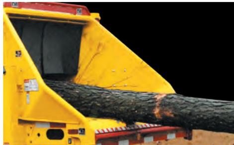
**AUSGEKLÜGELTES ZERKLEINERN.** Wenn sich die obere Einzugschwanzel hebt, erhöht sie automatisch den Anpressdruck auf das einzuziehende Material. Dies gestattet der oberen Einzugschwanzel ein einfacheres Aufnehmen von größeren Stämmen, bevor der erhöhte Anpressdruck mit max. Zugkraft für den Einzug angewendet wird.
