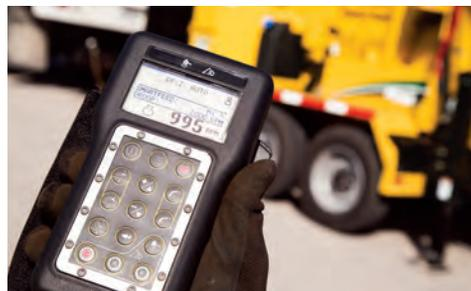
**OPTIONALE FERNSTEUERUNG.** Bedienen Sie ein Beladungsgerät und behalten Sie dennoch die Kontrolle über den Häckslers. Die Fernsteuerung hat die Funktionen Vorwärts, Rückwärts und Stopfunktion für die Einzugschwanzeln, Neustart der Einzugschwanzeln, Motordrosselung, Motorabschaltung, Druckerhöhung für die obere Einzugschwanzel und Positionierung des hydraulischen Auswurfs (falls damit ausgerüstet).
