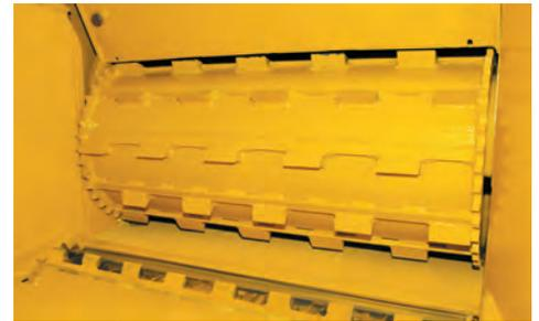
**UNTERE EINZUGSWANZEL.** Die untere Einzugschwanzel ist um 27,3 cm versetzt zur oberen Einzugschwanzel. Dadurch wird das Material leichter zur oberen Einzugschwanzel zugeführt.
