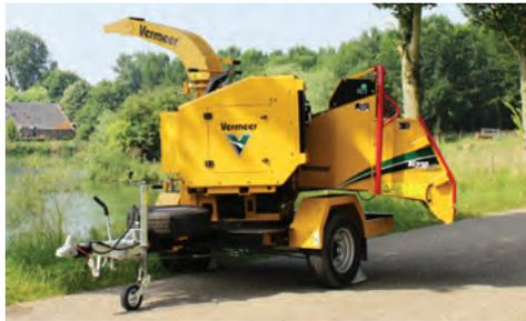
**OPTIONALER DREHKRANZ 180°.** Der optionale Drehkranz erlaubt dem Bediener den Einzug beliebig zu positionieren, das Beschicken des BC230XL wird somit erheblich erleichtert und eine erhöhte Sicherheit des Bedieners gewährleistet.
