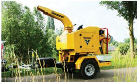
**KOMPAKTE GRÖSSE.** Mit allen verfügbaren Optionen und vollem Tank kommt der BC230XL auf ein Gesamtgewicht von 2.030 kg. Mit dem Zugfahrzeug garantiert das 1,9 m breite Fahrgestell des BC230XL ein stabiles Fahren und eine gute Sicht beim Rückwärtsfahren.
