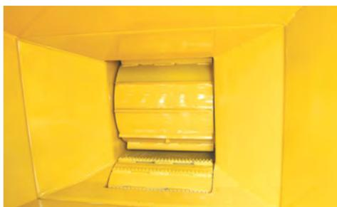
**HORIZONTAL VERSETZTE EINZUGSWALZEN.** Durch eine 23 x 35,5 cm große Einzugsöffnung mit horizontal voreinander versetzt gelagerten Einzugsrollen wird das Material leichter zum Hackprozess zugeführt und ein erleichteter Arbeitsprozess sichergestellt.
