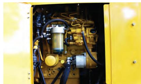
**STARKE LEISTUNG.** Der 50 kW (67 PS) Caterpillar Tier 4f (Stufe 3B) Turbo-Dieselmotor erfüllt nicht nur geltende Emissionsbedingungen, sondern bietet auch eine starke Leistung, um Ihre Häckselanforderungen voll zu erfüllen.
