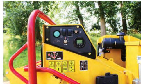
**ECOIDLE™ MOTORSTEUERUNGSSYSTEM.** Wählt der Bediener die Ecolidle-Funktion, sinkt die Motordrehzahl je nach Einstellung automatisch nach 60 Sekunden oder 5 Minuten Inaktivität auf eine voreingestellte Drehzahl. Beim Nichthäckseln wird somit Kraftstoff eingespart. Der Leerlauf führt zudem zu einer Reduzierung des Emissionsausstoßes und Geräuschpegels.
