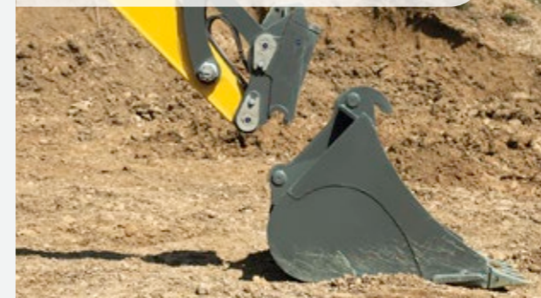
Umgekehrte Werkzeugaufnahme, z. B. zum Verschieben oder Glätten von Erde.
