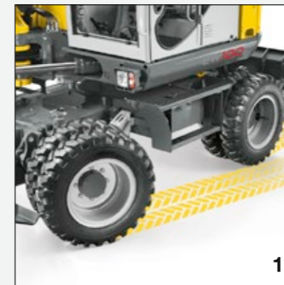
Vorderachsenlenkung für die schnelle Straßenfahrt.
