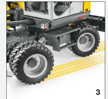
Hundeganglenkung für Parallelfahrten, z. B. an Gebäuden.
