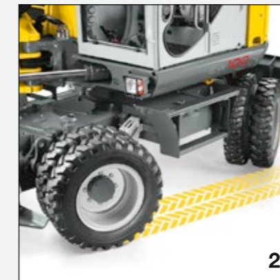
Allradlenkung für einen besonders kleinen Wendekreis.
