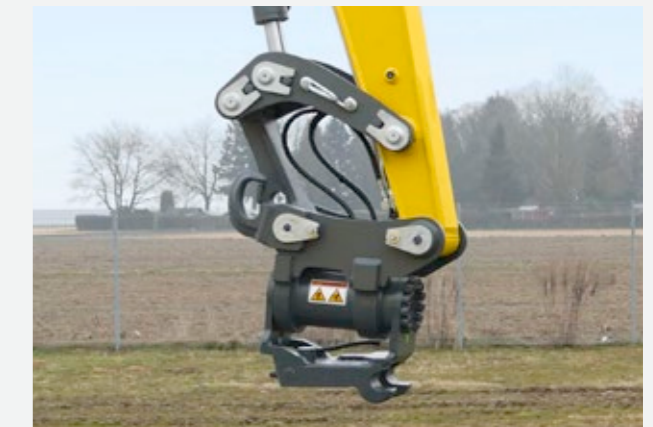
Powertilt mit hydraulischem Schnellwechsler Easy Lock.
