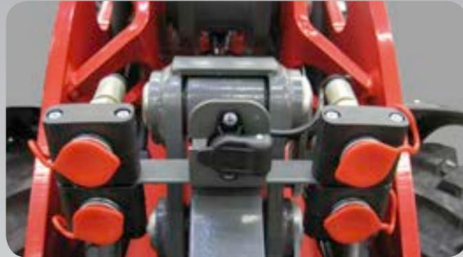
**Separater 4. Steuerkreis der unabhängig und einzeln zu bedienen ist (vorne und hinten möglich):**
