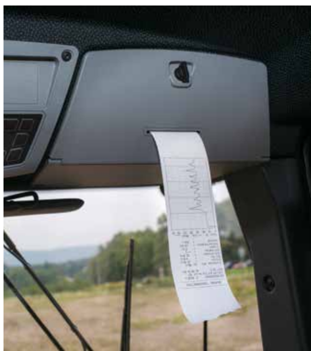
Integrierter Drucker: für die Dokumentation der Verdichtungswerte.
