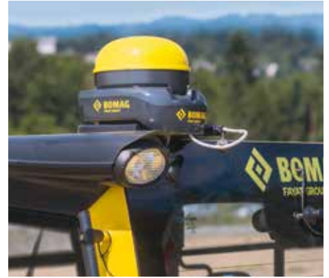
BOMAG StarFire: Präzision durch GPS.
