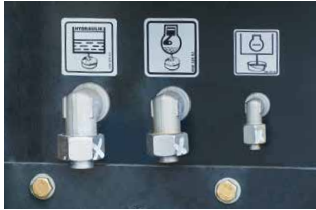
Intelligent: Betriebsmittel können von außen abgelassen werden.
