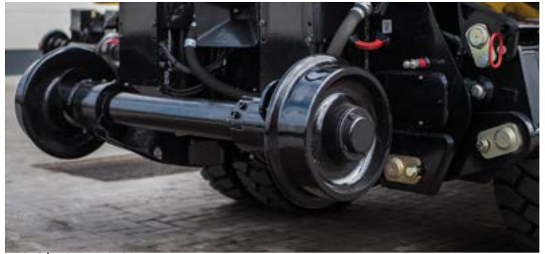
Friktionsantriebssystem lieferbar für 1404 ZW mit Gleisbreite 1000 und 1435 mm.
